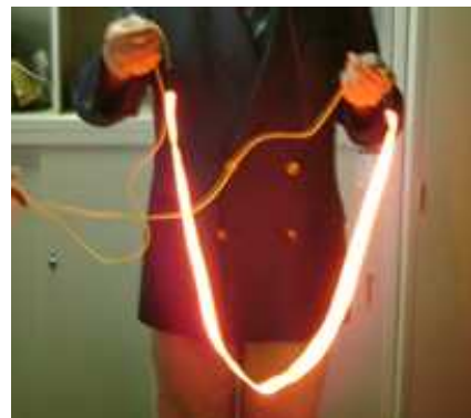
通電後約0.8秒、上昇温度は約800℃から1000℃に達している状態です。
