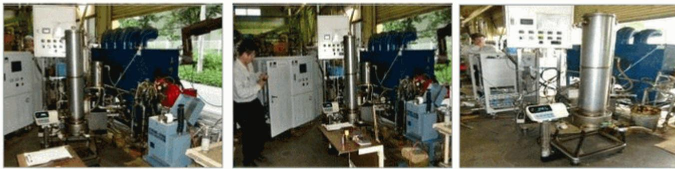
化石燃料のみの燃焼時の燃料消費量とエコエネガスシステムを使用し HHO ガスを混入させた'Hybrid Energy' を燃焼させた時の燃料消費量の変化を確認。
