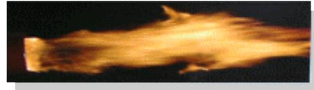
エコエネガスを混合させた化石燃料を燃焼させると温度が上がり、炎の長さが長くなります。
