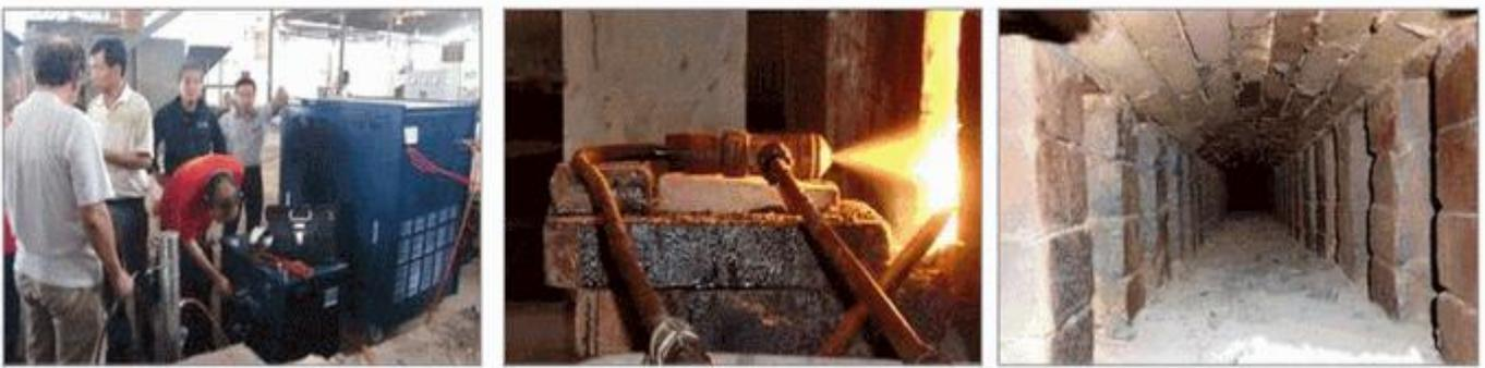
エコエネガスシステム設置後、火炎温度の上昇を以前の温度に合わせるために燃料を絞り対応。
