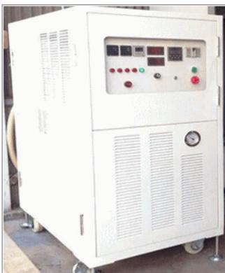
水道水もしくは井戸水を RO 浄水器に通してこのエコエネガス発生装置に取り込みます。取り込まれた水を特殊な電気分解方法で水素（H）と酸素（O）が混合状態の HHO ガス [酸水素ガス] として取り出す装置です。
